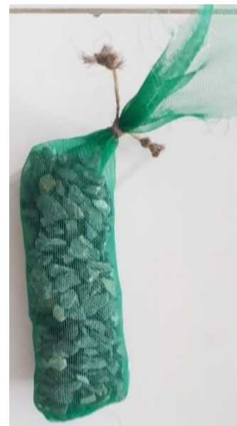
Figura 07: pedra brita envolta com tela de polietileno
