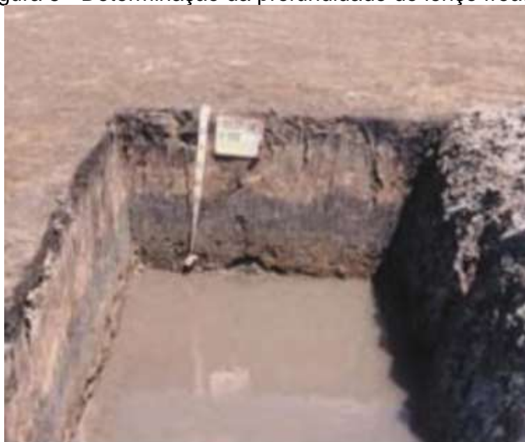
Figura 5 - Determinação da profundidade do lençol freático
