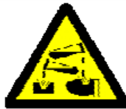
Perigo - Substâncias Corrosivas
