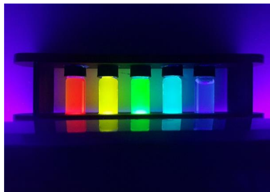
Quantum dots coloidais irradiados com luz ultravioleta
